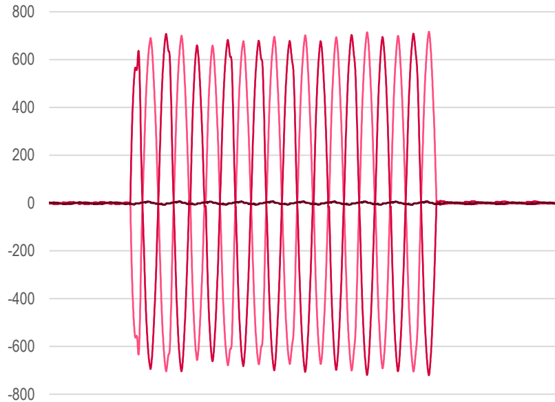
Corriente del transformador [A] - Sin filtro activo
